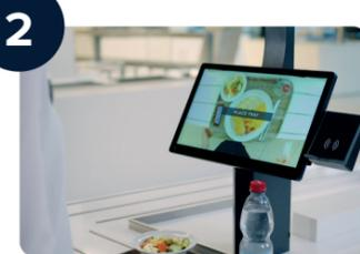
2 Per Kamera erkennt der Visioncheckout alle Artikel in unter 0,5 Sekunden
