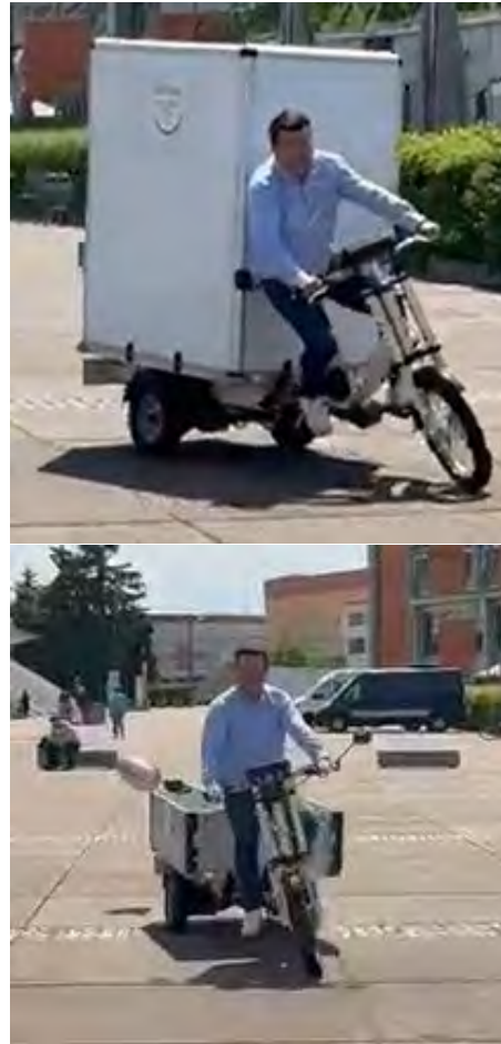
lastfreier Anhänger durch eigenen Antrieb
