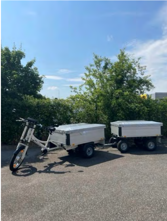
lastfreier Anhänger durch eigenen Antrieb
