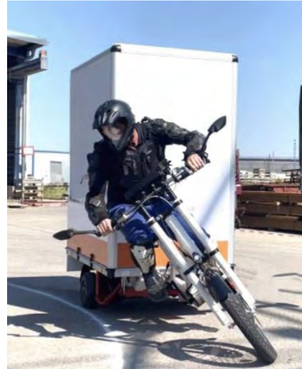
Intuitive Neigetechnik ermöglicht engste Kurvenfahrten
