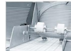
Steil geneigter Schlitten mit Leitschiene und Rippen für Antihaf-Effekt
