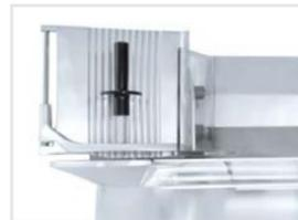
Schräg versetzt zurücklaufendes Anschlagsschwert für mehr Schnittfreiheit
