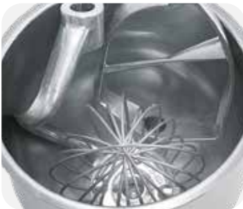
Für effizientes Arbeiten sind Kessel und Werkzeuge perfekt aufeinander abgestimmt. Die Rührmaschine startet den Rührvorgang nur, wenn der Kessel in der richtigen Position sitzt
