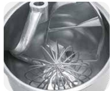
Für effizientes Arbeiten sind Kessel und Werkzeuge perfekt aufeinander abgestimmt. Die Rührmaschine startet den Rührvorgang nur, wenn der Kessel in der richtigen Position sitzt
